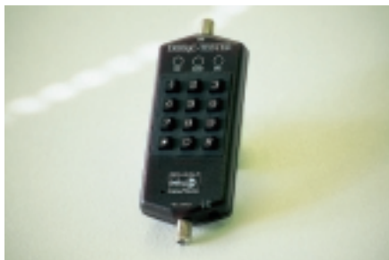
Fig. 20 Générateur de commandes DiSEqC™ 1.0 (EMITOR)
