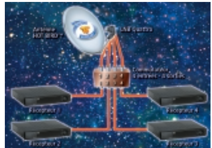
Fig. 6 Installation collective avec commutateur 4 entrées/4 sorties (DiSEqC™ 1.0)
