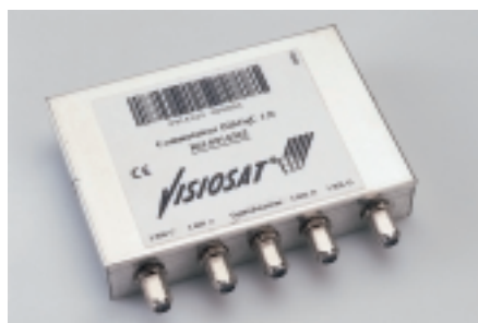
Fig. 9.b Commutateur DiSEqC™ 1.0 4 entrées/1 sortie (VISIOSAT)
